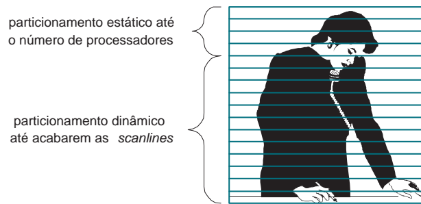
Figura 3.11: Particionamento dinâmico por scanlines .
